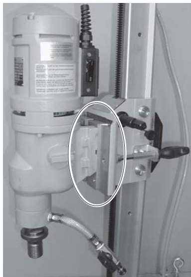
Рис. 3.37 Электромотор EM•3/4 с пластиной крепления тип С, 4832 смонтированные на салазках Н•201 (Позиция (1) для более длинного хода)
