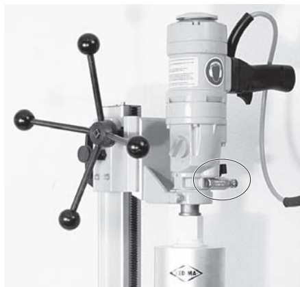
Рис.3.65 Водяной разъем на EM•3/2 НТ
