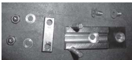
Рис. 3.54 Пластина крепления гидроцилиндра с крепежными деталями
