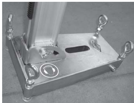
Рис. 3.14 Юстировочные винты с контрагайками на системе Н•201-Uni
