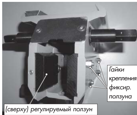
Рис. 6.3 Снятые салазки Н•201 (Вид сверху регулируемый ползун)
