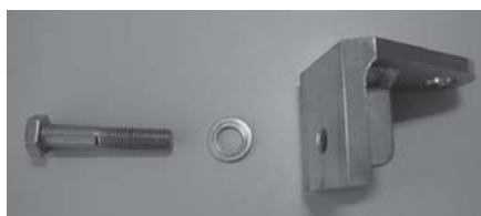
Рис. 3.52 Крепежный винт, шайба и уголок-держатель гидроцилиндра
