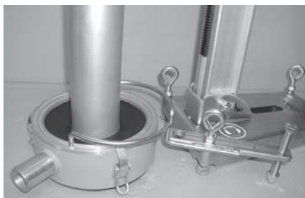
Рис. 3.50 Водосборное кольцо с держателем на сверильной коронке
