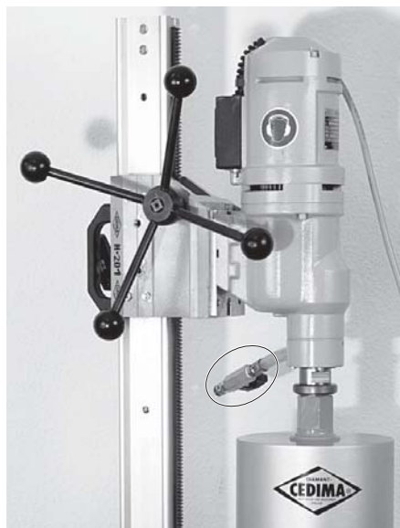
Рис. 3.66 Водяной разъем на EM•3/4
