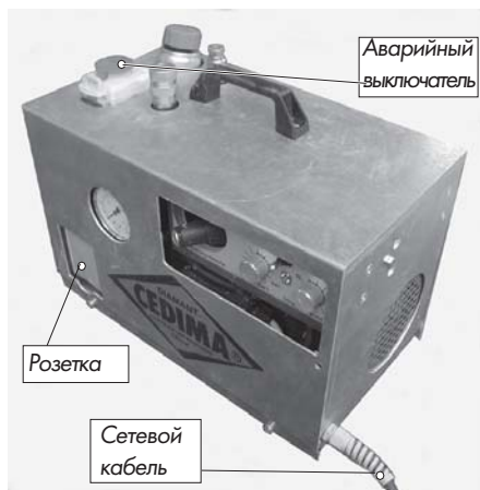
Рис.4.1 Маслостанция HAG•1 для привода автоматической подачи
