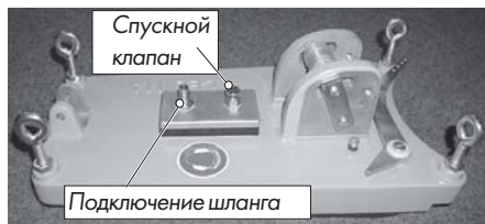
Рис. 3.19 Подножка Н•201-Primo вид сверху с комплектом вакуумного крепления
