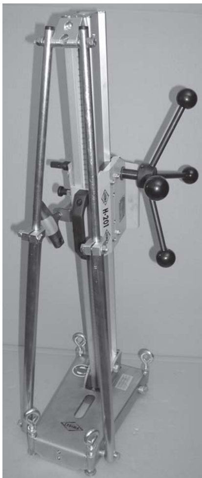
Рис. 3.42 Смонтированная на системе Н•201- Uni двойная опора
