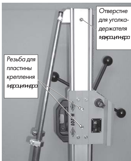
Рис. 3.51 Сверильный стяк Н•201 (с двойной опорой), подготовленный для монтажа системы автоматической подачи
