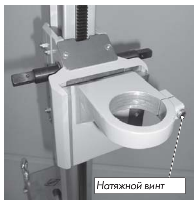
Рис. 3.29 Пластина крепления для моторов с монтажной шейкой (тип В, 4831) смонтированная на салазках Н•201 (Позиция 1)
