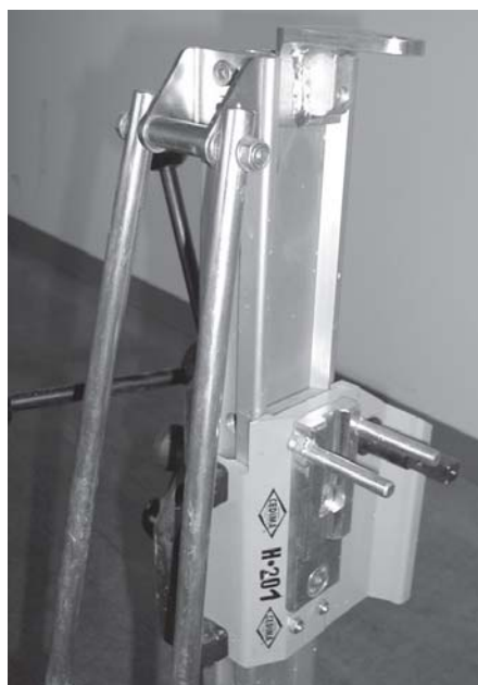
Рис. 3.57 Уголок-держатель и пластина крепления гидроцилиндра, привинчены к Н•201
