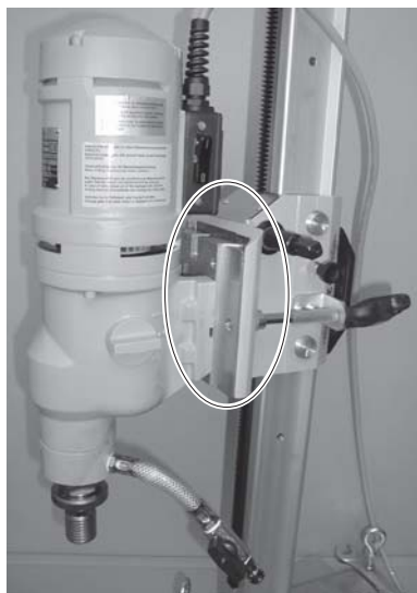
Рис. 3.38 Электромотор EM•3/4 с пластиной крепления тип С, 4832 смонтированные на салазках Н•201(Позиция (2))
