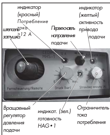
Рис.4.2 Элементы управления маслостанции HAG•1
