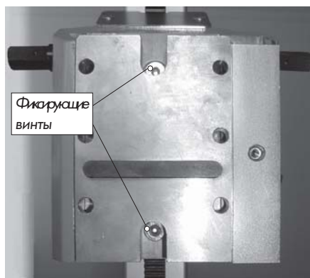
Рис. 3.28 Цилиндрические винты (фиксирующие винты на монтажной стороне) салазок Н•201 и соотв. пазы пластины крепления (тип С, 4832)
