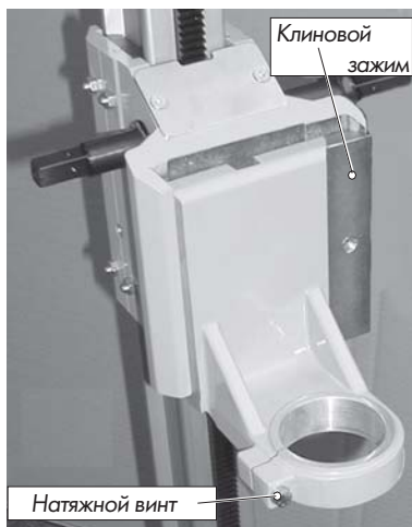
Рис. 3.30 Пластина крепления моторов с монтажной шейкой (тип В, 4831) закреплена на салазках Н•201 (Позиция 2)
