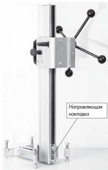
Рис.3.6 Сверлильный стояк Есо на дюбельной подножке Н•201-Есо
