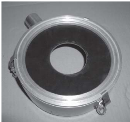
Рис. 3.46 Водосборное кольцо с натянутым уплотнительным кольцом (для Ж 81 мм коронки) и прижатой крышкой (-кольцом)
