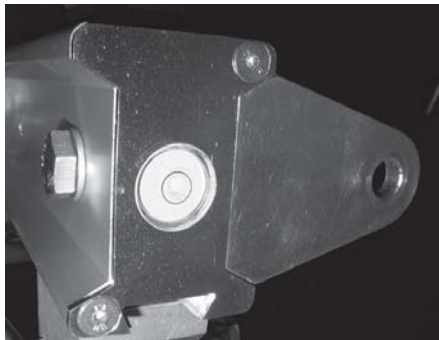
Рис. 3.53 Уголок-держатель, завинченный на сверильный стоик Н•201-Uni
