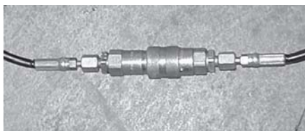
Рис. 3.62 Гидроразъемы шлангов, соединенные при их перемещении
