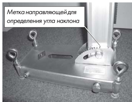
Рис.3.3 Универсальный сверлильный стоек, установлен на дюбельную подножку Н•201-Uni
