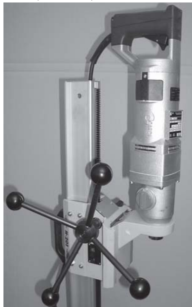
Рис. 3.31 Смонтированный с пластиной крепления мотор EM•1850 с монтажной шейкой на салазках Н•201 (Позиция 1)
