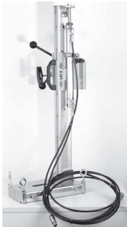
Рис. 3.60 Гидроцилиндр с гидрошлангами и гидроразъемами, смонтированные на системе H•201
