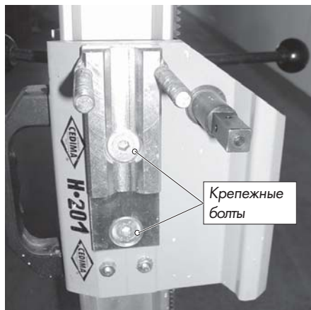
Рис. 3.56 Закрепленная на салазках Н•201 пластина крепления гидроцилиндра
