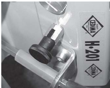
Рис.3.10 Стопор на салазках Н•201 активирован
