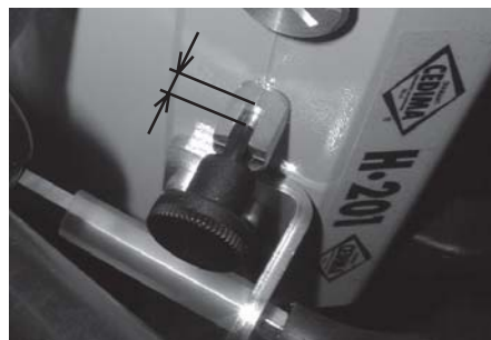
Рис.3.9 Стопор салазок Н•201 активирован, в положении „застопорено“
