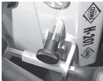
Рис. 3.11 Салазки Н•201расстопорены (могут перемещаться по стояку)
