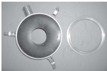
Рис. 3.45 Уплотнительное кольцо (для Ж 81 мм коронки), надетое на водосборное кольцо
