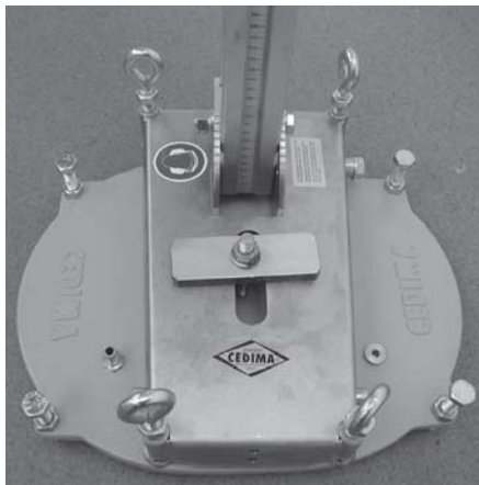
Рис. 3.22 Сверильная система Н•201-Uni, закрепленная к вакуумной плите VP•150
