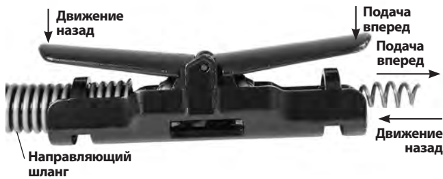
Рис. 9 – Рычаг подачи троса вперед/движения назад
