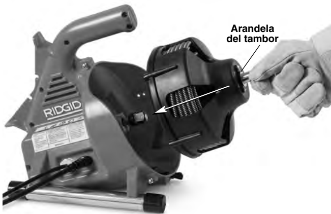
Figura 16 – Colocación del tambor dentro de la máquina
