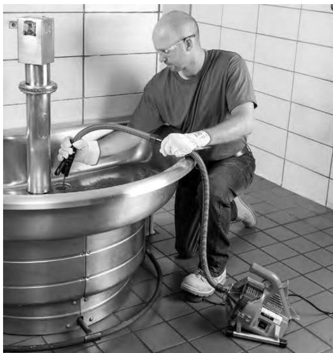
Obrázok 11 – Vyťahovanie špirálového kábla
