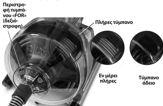
Εικόνα 10 – Παρακολούθηση του σπιράλ στο τύμπανο
