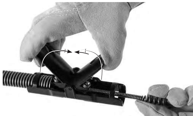
Rysunek 5 - Wprowadzanie kabla przez zespół AUTOFEED®
