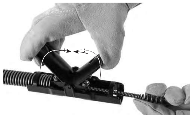
Obrázek 5 – Zavádění kabelu skrze sestavu AUTOFEED®
