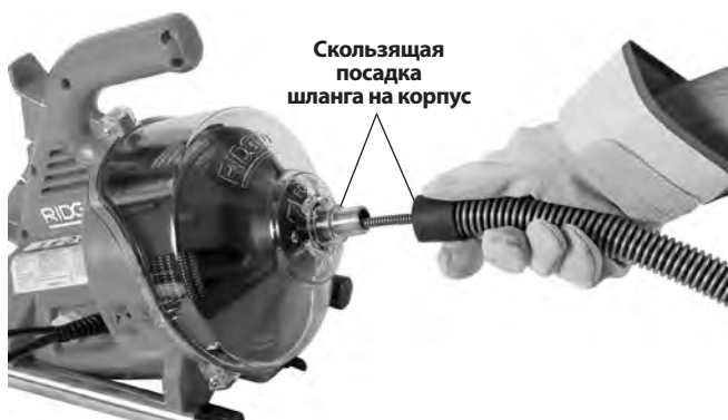
Рис. 4 – Подача троса в направляющий шланг
