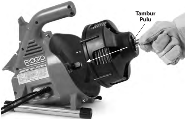
Şekil 16 – Tamburun Makineye Yerleştirilmesi
