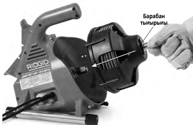
16-сурет – Барабанды құрылғы ішіне енгізу
