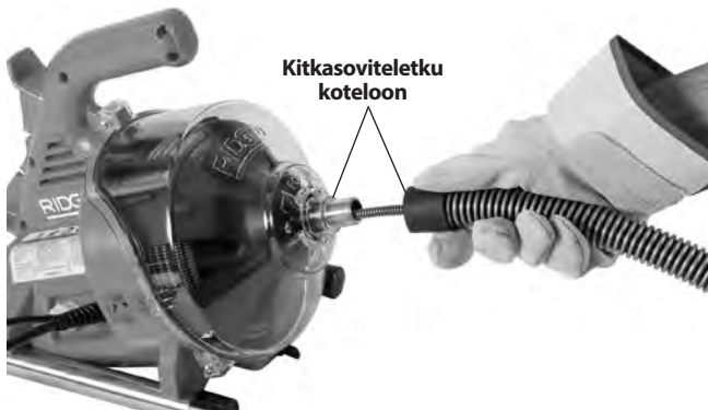
Kuva 4 – Jousen syöttäminen suojaletkun läpi
