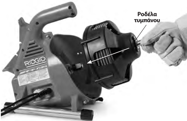
Εικόνα 16 – Τοποθέτηση του τύμπανου στο μηχάνημα
