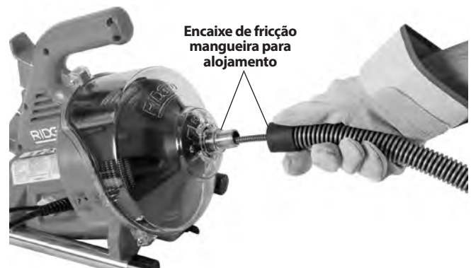
Figura 4 – Avançar o cabo para a mangueira guia
