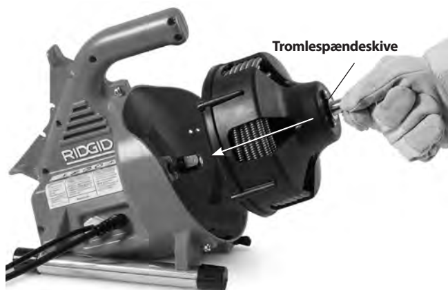
Figur 16 – Montering af tromlen i maskinen
