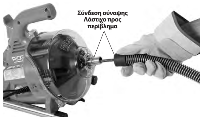
Εικόνα 4 – Προώθηση του σπιδάλ στον λαστιχένιο οδηγό
