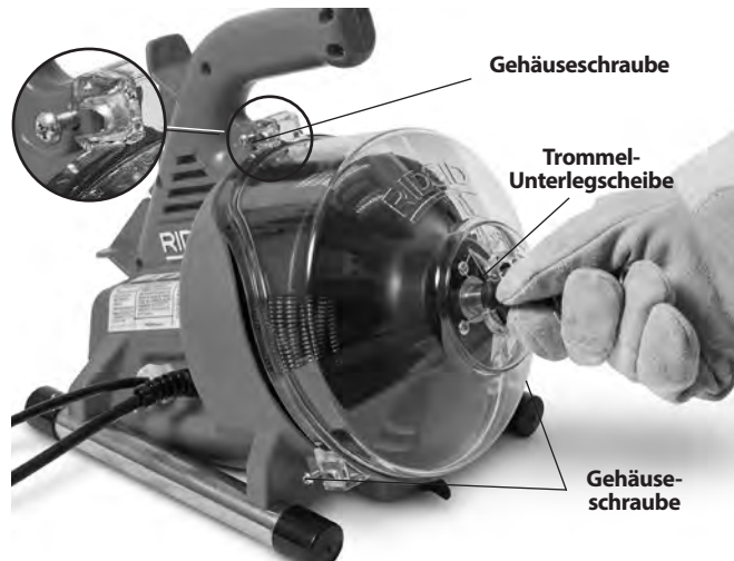
Abbildung 13 – Öffnen des Rohreinigers
