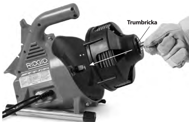
Figur 16 – Sätta i trumman i maskinen
