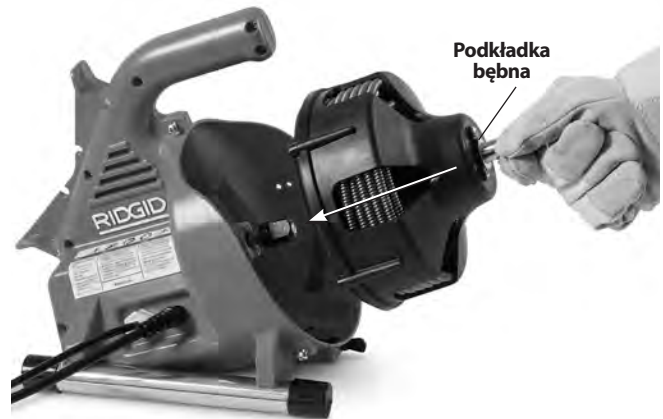
Rysunek 16 - Wkładanie bębna do maszyny
