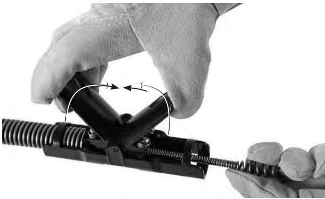
Abbildung 5 – Führen der Spirale durch die AUTOFEED®-Einheit
