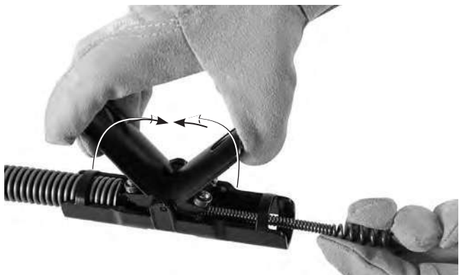
Εικόνα 5 – Τροφοδοσία του σπιδάλ μέσα από το συγκρότημα AUTOFEED®
