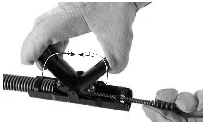
Figura 5 - Inserimento del Cavo attraverso l'assemblaggio dell'AUTOFEED®
