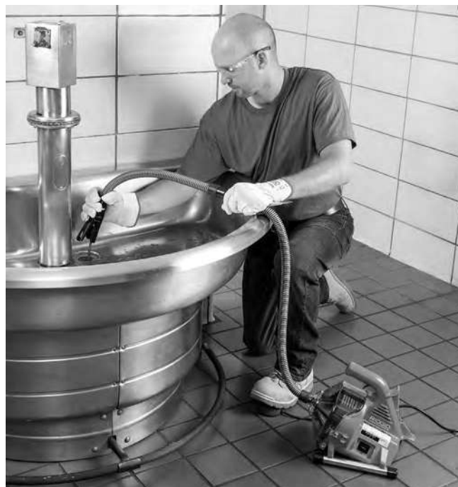
Figur 11 - Tilbagetrækning af spiralen
