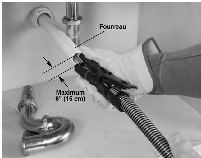
Figure 7 – Exemple d'un fourreau amenant le câble exposé à moins de 6" (15 cm) du système AUTOFEED
