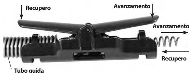
Figura 9 – Avanzamento/Ritrazione della Leva di inserimento
