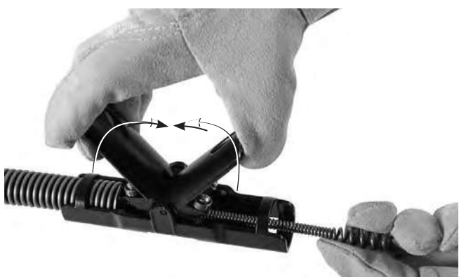
Рис. 5 – Подача троса сквозь узел AUTOFEED®
