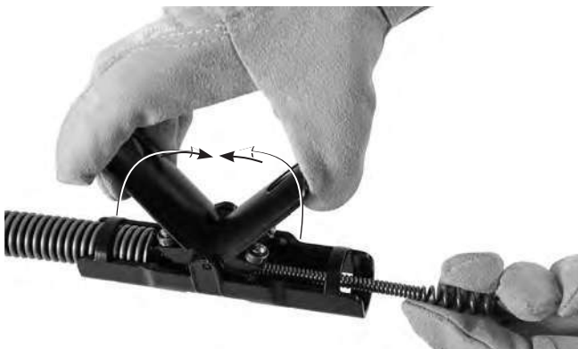
Kuva 5 – Jousen syöttäminen AUTOFEED®-kokoonpanon läpi
