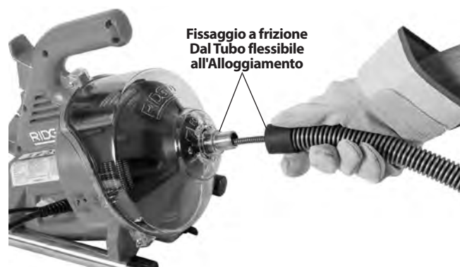
Figura 4 - Inserimento del Cavo nel Tubo guida
