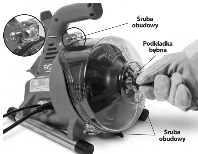
Rysunek 13 - Otwieranie maszyny do czyszczenia odpływów
