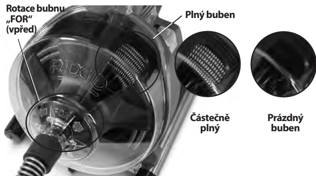
Obrázek 10 – Sledování kabelu v bubnu
