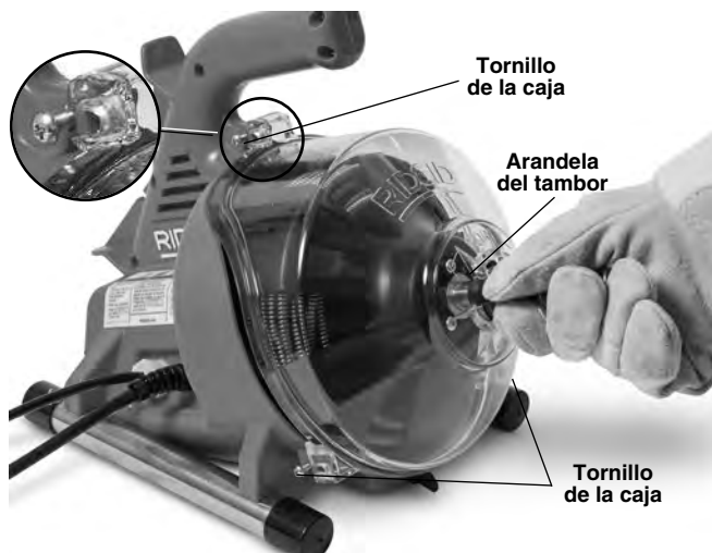
Figura 13 – Apertura de la limpiadora de desagües
