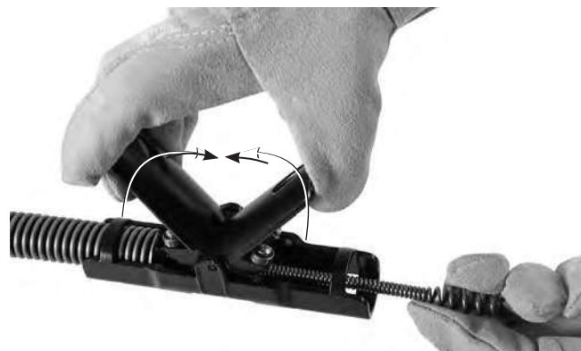
5-сурет – Кабельді AUTOFEED® жиынтығы арқылы өткізу
