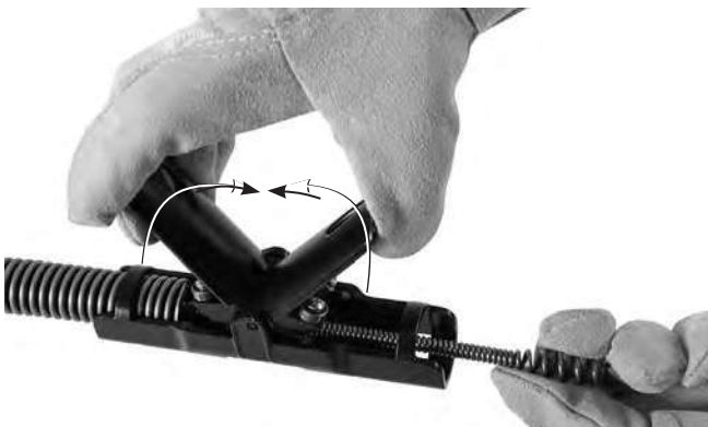
Figuur 5 – De kabel door de AUTOFEED®-eenheid voeren
