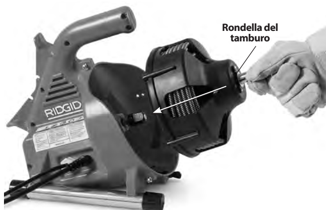
Figura 16 – Inserimento del Tamburo nella Macchina
