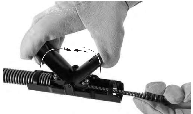
Slika 5 – Dovajanje kabla skozi sestav AUTOFEED®
