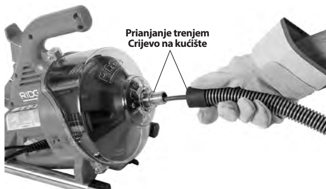
Slika 4 - Uvlačenje kabela u gibljivu cijev za vođenje
