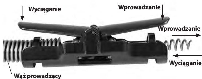
Rysunek 9 – Dźwignia posuwu postępowego/cofającego
