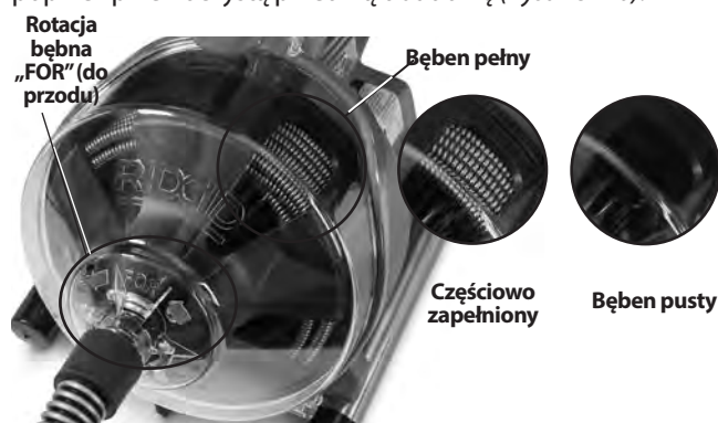
Rysunek 10 - Obserwowanie kabla w bębnie
