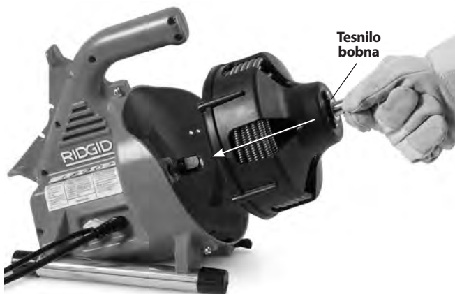
Slika 16 – Vstavljanje bobna v stroj
