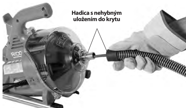
Obrázok 4 – Podávanie špirálového kábla do vodiacej hadice
