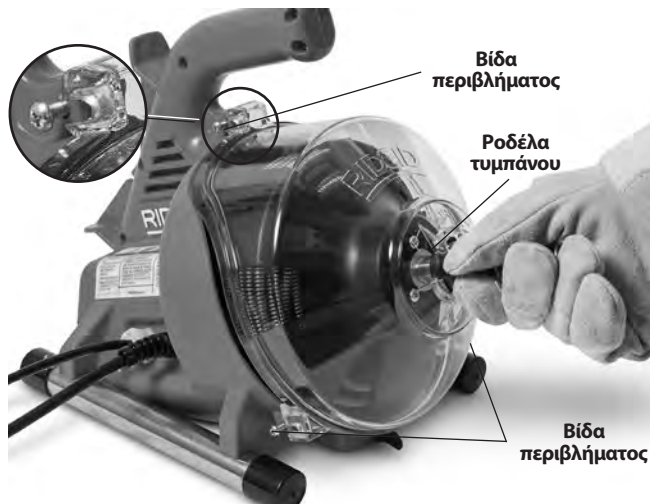
Εικόνα 13 – Άνοιγμα του μηχανήματος απόφραξης αποχετεύσεων
