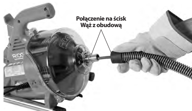
Rysunek 4 - Wprowadzanie kabla do węża prowadzącego
