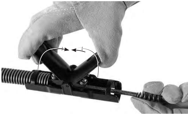
Şekil 5 – Kablo ucu kapağını AUTOFEED® Montajı Boyunca Besleme
