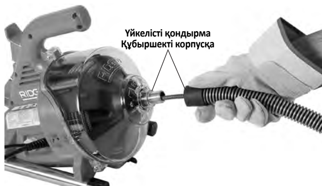
4-сурет – Кабельді бағыттауыш құбыршекке өткізу
