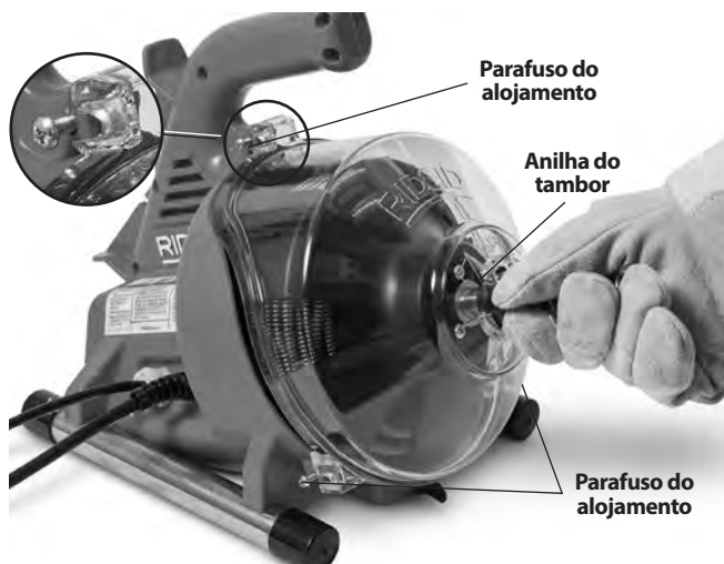
Figura 13 – Abrir a máquina de limpeza de tubagens
