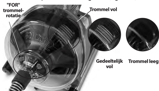
Figuur 10 - De kabel in de trommel controleren
