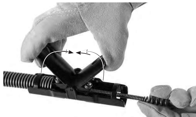
Figura 5 – Avansarea cablului prin ansamblul AUTOFEED®
