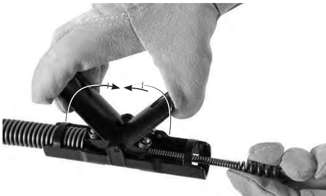
Slika 5 – Provođenje sajle kroz AUTOFEED® sklop
