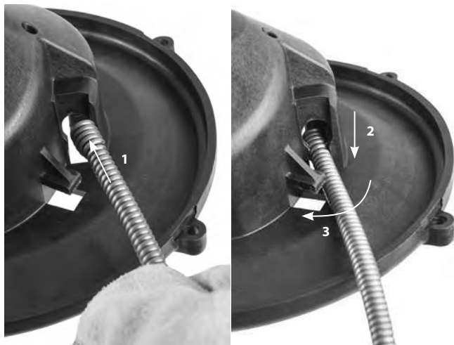
Figur 15 – Fästa spiralen på innertrumman
