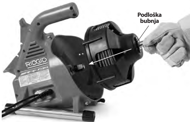
Slika 16 - Umetanje bubnja na uređaj
