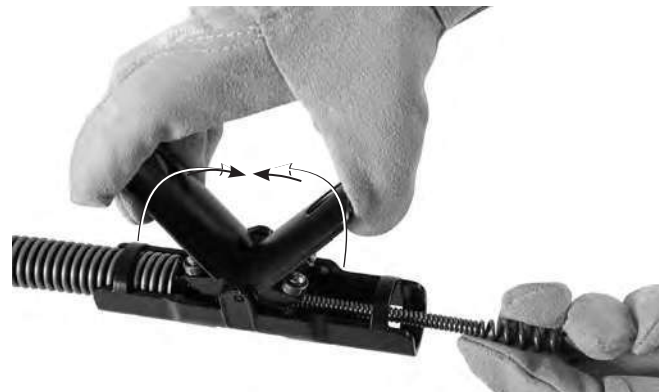
Figura 5 – Avançar o cabo através da montagem AUTOFEED®
