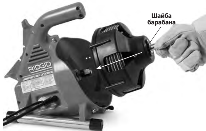
Рис. 16 – Установка барабана в машину
