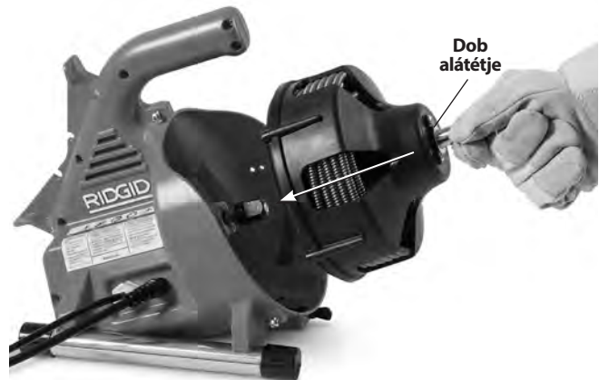
16. ábra – A dob behelyezése a gépbe
