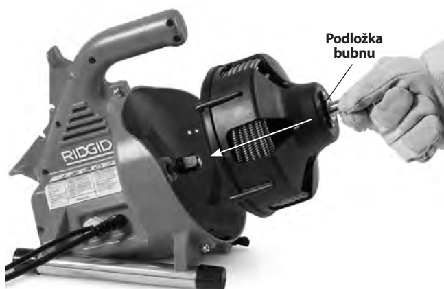
Obrázek 16 – Vložení bubnu do nástroje
