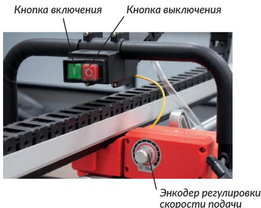
**Внимание!** Питание на водяную помпу осуществляется только при включении двигателя станка. Рекомендуем заранее перевести выключатель помпы в режим «Включено».
